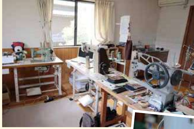
襦づくりを助ける3台のミシン。縫う作業は千鳥ミシンとポストミシン、八方ミシンは針を通すガイド穴を開けるのに使っている
