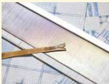
かなおき 金箆／たて糸に通されたよこ糸の目を詰める作業に使用する櫛状の道具で、たて糸を絡まないようにする、よこ糸を強く織り込む、また箆羽（櫛の歯の部分）に1,200本の糸を1本1本通すことで織り幅を一定に保つといった役割がある
