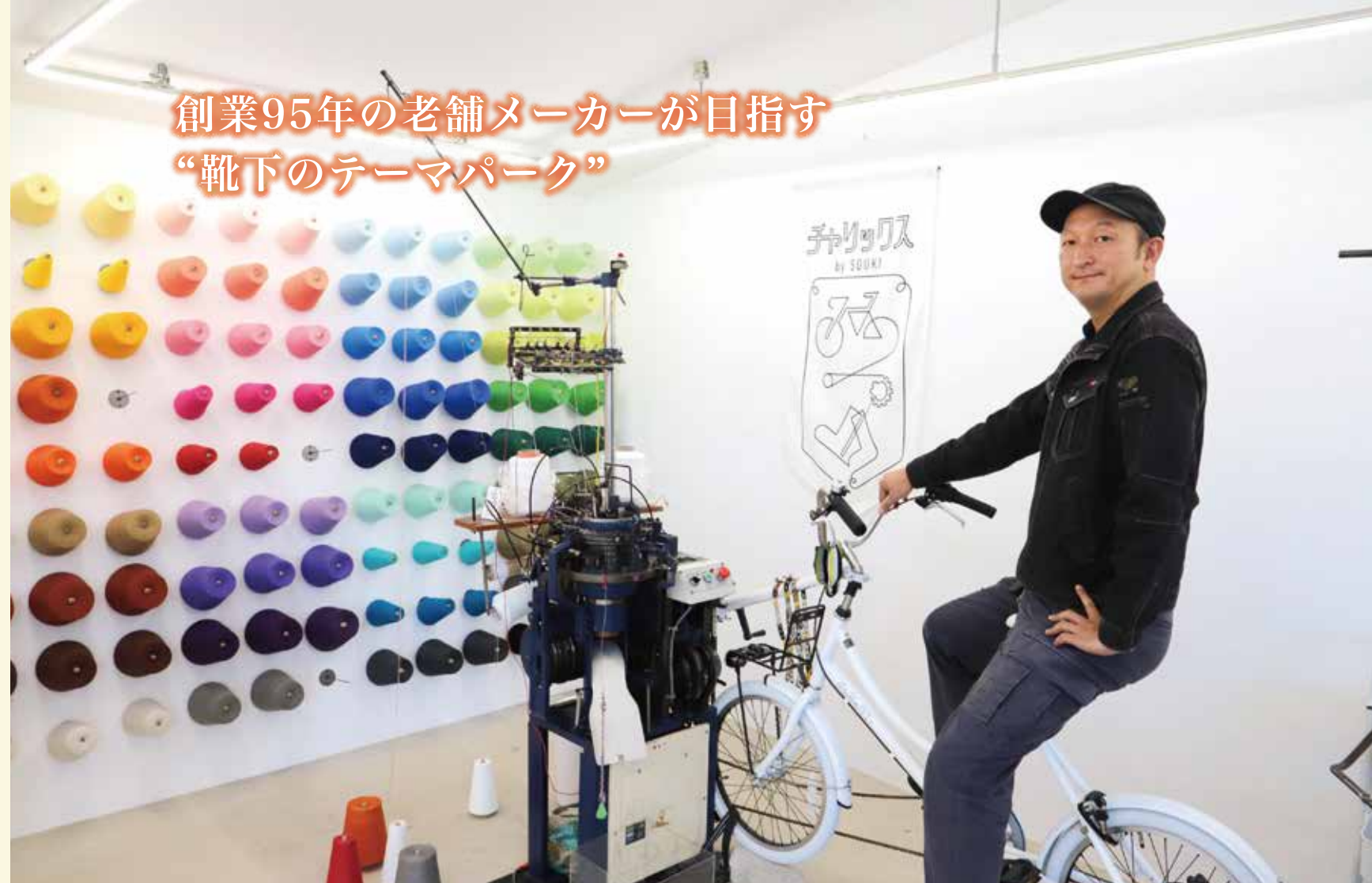
チャリックス／編み機を自転車で動かして、オリジナルの靴下ができあがる
