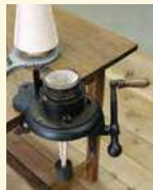
手回しの編み機 (写真提供：広陵町)
