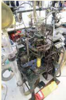
約40年前の編み機。今では生産さ れていないので、自分たちでメンテ ナンスを行っているそう
