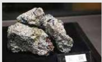
原料の玉鋼。たたら製鉄の技法でつくられる鉄と炭素の合金
